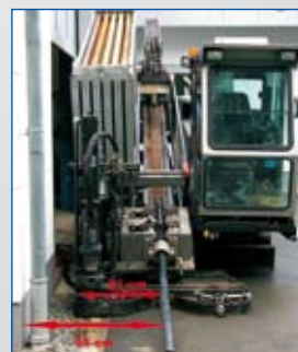
GRUNDODRILL 15 N Total width 2,06 m
